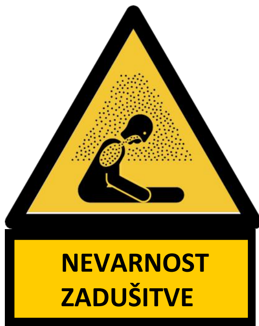
Slika 3 Simbol v skladu z ISO 7010 W041 z opozorilnim besedilom
